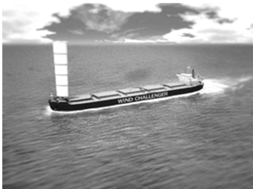
図7 ウィンドチャレンジャー硬翼帆（展帆時及び縮帆時）
