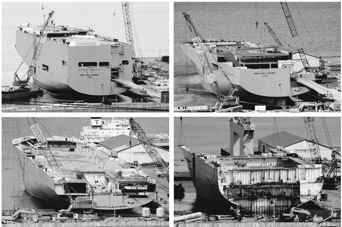
写真7. PCC解体作業の流れ
