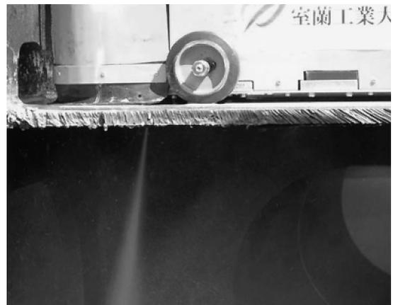
写真11. 船体底部の切断試験
